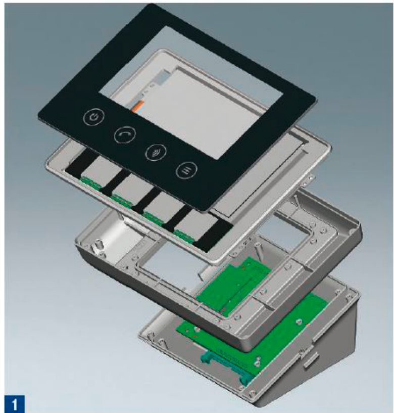
Bild 1: Bedieneinheit Interface-Terminal mit den Einzelkomponenten, die darin verbaut werden.
